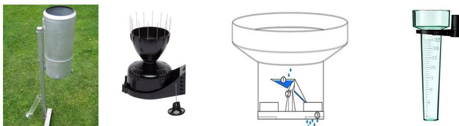
Tous les pluviomètres sont faits d'un matériel étanche à l'eau, ce qui veut dire qu'ils ne laissent pas traverser l'eau. Ce dispositif est important car la Terre absorbe l'eau des pluies et il nous permet donc de savoir combien il a plu pendant une journée, une semaine ou une année. Les pluviomètres nous permettent donc de savoir la quantité d'eau qui est tombée grâce à un calcul de conversion et de multiplication.
